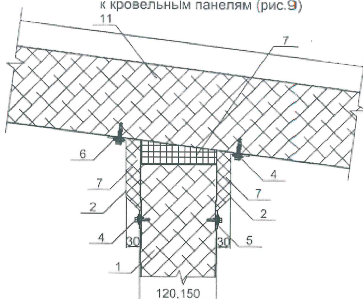
Примыкание противопожарной стены к кровельным панелям (рис.9)
